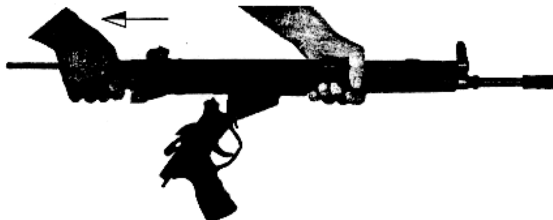
Fig. 64: Remove bolt assembly
